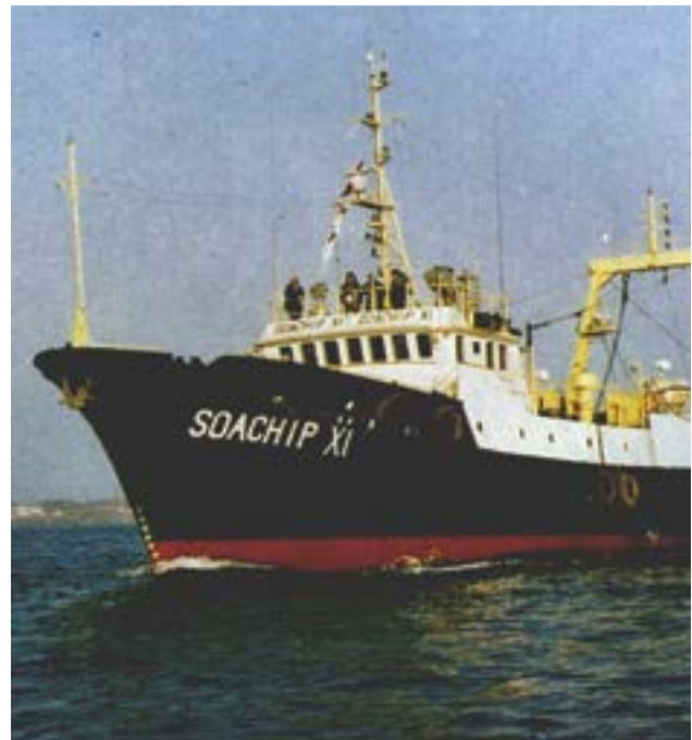
Type 8160, TB 299, chalutier à rampe arrière, fabriqué par "Dalian Fishing Vessel Company", Extrait de Atlas of Chinese Steel Marine Fishing Vessel, Page 7
