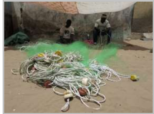
Photo #2 : Montage d' un filet à sole en fil monofilament - St Louis - SN - 06/2013
